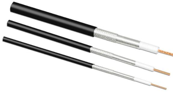
射频电缆，是一种类型的电缆由内的导体由一同心包围导电屏蔽，与由分开的两个电介质（绝缘材料）；许多射频电缆还具有保护性外套或护套。术语“同轴”是指共享几何轴的内部导体和外部屏蔽。射频电缆是一种传输线，用于传输低损耗的高频电信号。它用于电话干线、宽带互联网电缆、高速计算机数据总线、有线电视信号以及将无线电发射器和接收器连接到天线的应用。它与其他屏蔽电缆的不同之处在于，电缆和连接器的尺寸受到控制，以提供精确、恒定的导体间距，这是使其有效用作传输线所必需的。射频电缆用于xxx批（1858年）和随后的跨大西洋电缆安装，但直到1880年，英国物理学家、工程师和数学家奥利弗·海维赛德[Oliver Heaviside]才对射频电缆的理论进行了描述。为了正确地选用射频电缆就需要学习了解一些有关电缆的特性参数和类型。低损耗电缆生产公司
