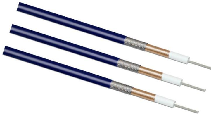
射频电缆主要分为半刚性、半柔性、柔性和波纹铜管电缆，不同的应用场合应选择不同类型的电缆。半刚性电缆，顾名思义，这种电缆不容易被较易弯曲成形，其外导体是采用铝管或者铜管制成，其射频泄漏非常小（小于-120dB）在系统中造成的信号串扰可以忽略不计。这种电缆的无源互调特性也是非常理想的。如果要弯曲到某种形状，需要专门的成形机或者手工的模具来完成。如此麻烦的加工工艺换来的是非常稳定的性能，半刚性电缆采用固态的聚四氟乙烯材料作为填充介质，这种材料具有非常稳定的温度特性，尤其在高温条件下，具有非常良好的相位稳定性。半刚性同轴测试线缆，半刚性电缆的成本高于半柔性电缆，大量应用于各种射频和微波系统中。半柔性电缆是半刚性电缆的替代品，这种电缆的性能指标接近于半刚性电而且可以手工成形，但
