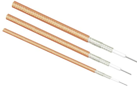
常见的射频电缆由绝缘材料隔离的铜线导体组成，在里层绝缘材料的外部是另一层环形导体及其绝缘体，然后整个电缆由聚氯乙烯或特氟纶材料的护套包住。射频电缆的纺织网线对射频电缆的屏蔽性能起着重要作用，而且在集中供电有线电视线路中还是电源的回路线，因此射频电缆质量检测必须对纺织网是否周密平整进行检查，方式是剖开射频电缆外护套，剪一小段射频电缆编织网，对编织网数量进行判定，如果与所给指标数值相符为合格，另外对单根纺织网线用螺旋测微器进行勘测，在同等价格下，线径越粗质量越好。
